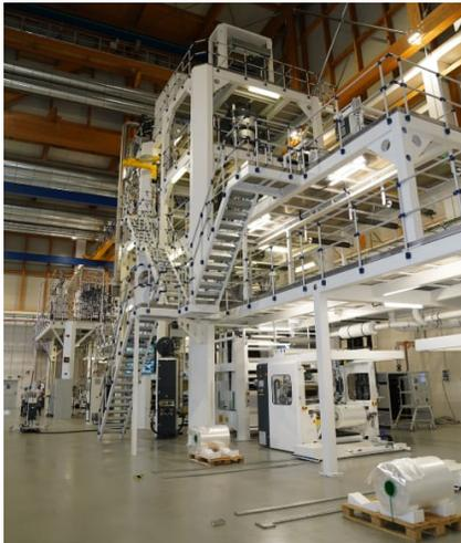
L'impianto di coestrusione con bi-orientazione in bolla inaugurato ieri alla presenza delle autorità si estende su una superficie di 8.500 m<sup>2</sup> ed è dedicato alla produzione di film lid e bottom per termoformatura con spessori ridotti, sacchi termoretraibili barriera e non; prodotti che rispondono alla domanda di imballi flessibili sempre più sottili e facili da riciclare.
